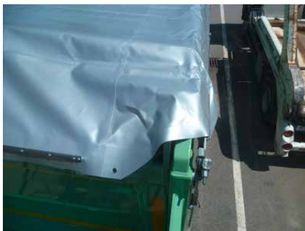
Volquete trilateral: la lona cubre completamente el rodamiento de la trampilla posterior.
