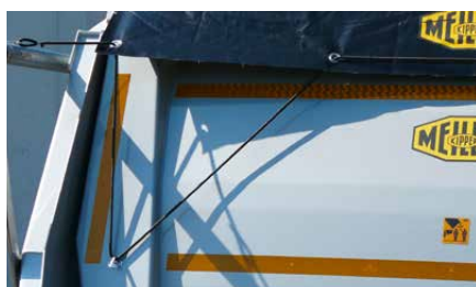
Volquete de descarga trasera: con los ganchos bajos el tensado de la lona resulta más cómodo.
