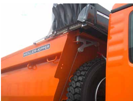
Volquete de descarga trasera: se puede combinar con la rueda de repuesto en la pared frontal.
