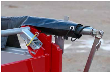
El tubo de avance plegable evita que se produzcan daños.
