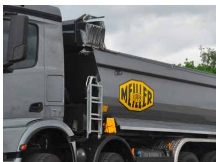
Volquete de descarga trasera: escalerilla con agarradero en el soporte de la lona.
