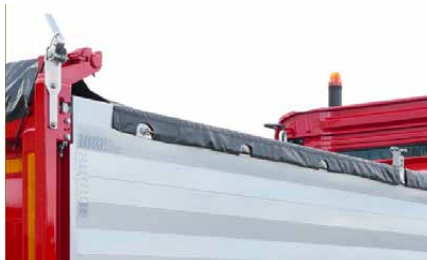
El rodamiento excéntrico en la correa superior de la caja basculante permite retensar la lona desenrollable lateral.
