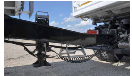
El saliente de la lanza con un asidero en la pata de apoyo facilita la apertura y el cierre de la lona desenrollable lateral en el remolque de eje central.
