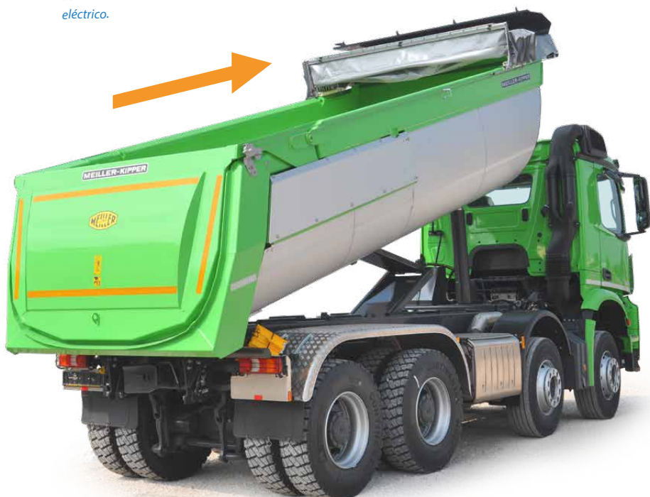
Volquete de descarga trasera de MEILLER con toldo corredizo eléctrico.
