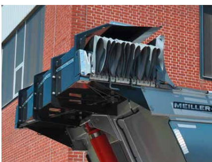
El techo de lona protector sirve de protección durante la carga
