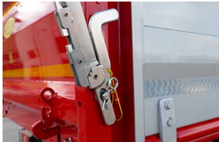
Operación conforme a la ley: gracias a la manivela plana se mantiene la anchura exterior máxima.
