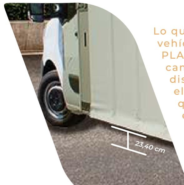
Lo que caracteriza a este vehículo botellero tipo PLANCHER es la prácticamente inexistente distancia que hay entre el piso y el suelo, lo que disminuye el esfuerzo y evita lesiones de los operarios.
