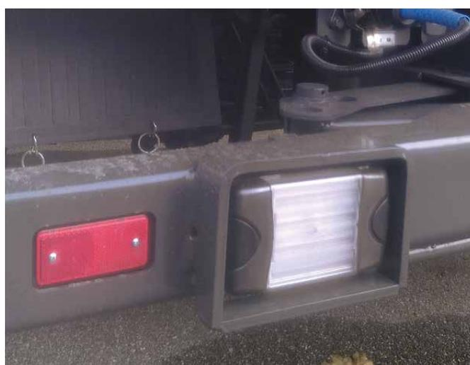
Dispositivo de iluminación en el antiempotramiento
