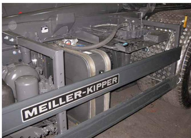
Montaje de depósito de aceite y antiempotramiento lateral
