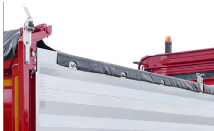
Exzenterlager am Obergurt der Kippbrücke ermöglicht die Nachspannung der seitlichen Rollplane.
