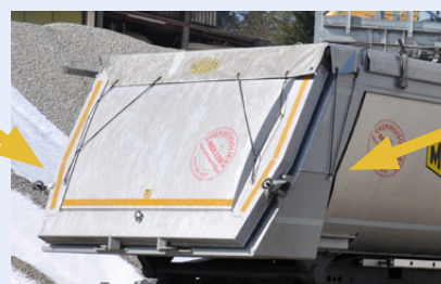
Einfaches Handling mit der verstellbaren Kurbel mit umlaufender Verzahnung.
