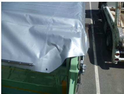
Dreiseitenkipper: Plane deckt Rückwandlager vollständig ab.
