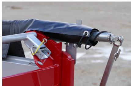
Klappbares Laufrohr verhindert Beschädigungen.
