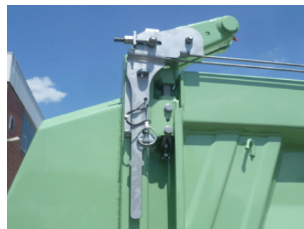
Dreiseitenkipper: Seile abnehmbar durch Schnellverschluss.
