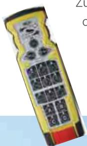
Zusatzfunktionen wie Motor-Start/Stopp, das Bedienen der Arbeitsscheinwerfer oder des Unterfahrschutzes hinten, können zentral über i.s.a.r-Controll gesteuert werden.
