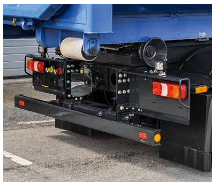
El dispositivo antiempotramiento, siempre en el lugar correcto: plegado al volcar y rodar, desplegando al circular.
