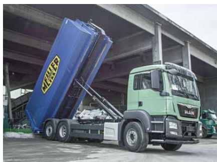
Mayor margen en los lugares bajo techo gracias al volquete más bajo de la caja basculante sobre rodillos.
