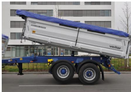
La más indicada para transportar pesados bloques de piedra, ya que gracias a su robusta forma constructiva, **el remolque MZDA18.22 soporta las sobrecargas sin esfuerzo**, incluso fuera de carreteras asfaltadas.
