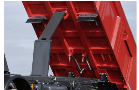
El estabilizador de tijera MEILLER proporciona seguridad durante el proceso de vuelco.
