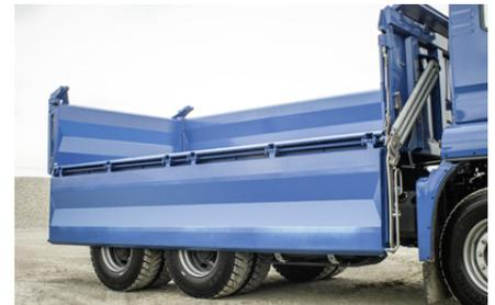
*Pared lateral con suspensión pendular y abatible con aligeramiento de muelle.*
