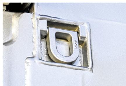
Los ojales de amarre giratorios en la pared frontal mantienen el material de transporte sujeto hacia delante.
