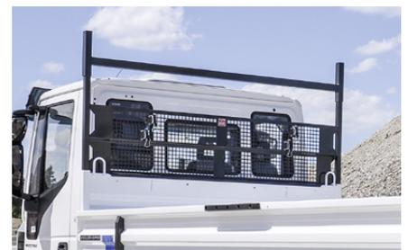
*Estructura de apoyo con soporte de pala y escoba*
