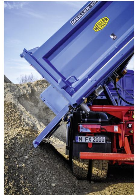
Bordmatik con ángulo de abatimiento de 90°: el material suelto se descarga desde una posición alejada del vehículo.
